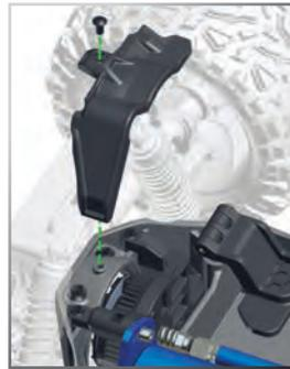
Posición del tornillo del motor en el adaptador de engranaje fijo para ajustar la rueda dentada
